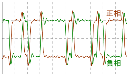
(A) 10Gbps 擬似ランダム信号、スキュー：20ps コモンモードチョークコイル (1)*
